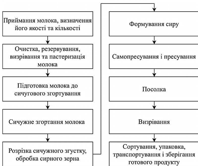
Рисунок 1 – Технологічні стадії виробництва сирів [5]
