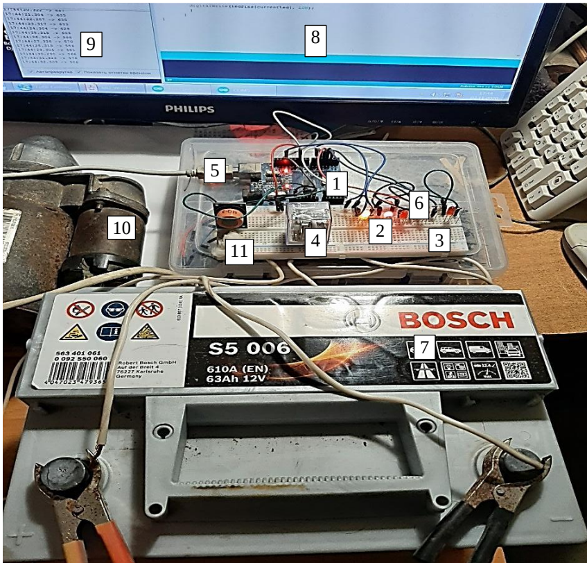
Рисунок 2 – Експериментальна перевірка блокувального пристрою з автомобільними акумулятором і стартером
