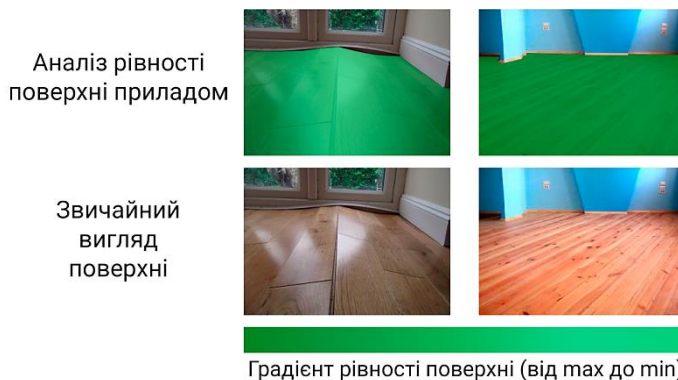
Рисунок 3 – Приклад результату аналізу рівності поверхні (підлоги) приладом та градієнт, за яким вимірюється якість
