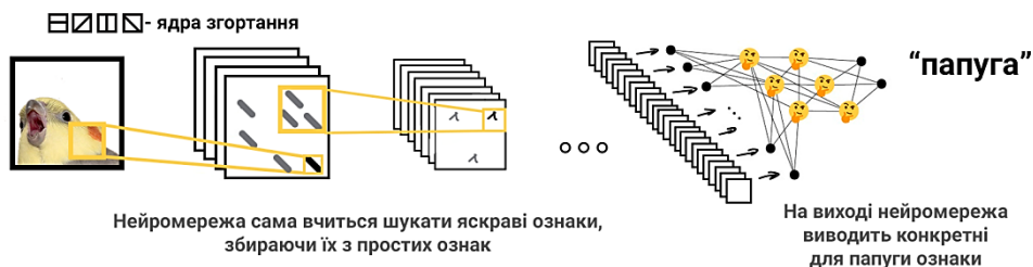
Рисунок 1 – Принцип роботи згорткової нейромережі на прикладі папуги
