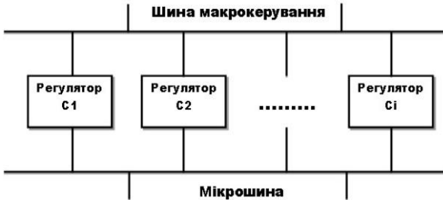
Рисунок 2 – Реалізація змінної структури Сі – локального модуля-регулятора
