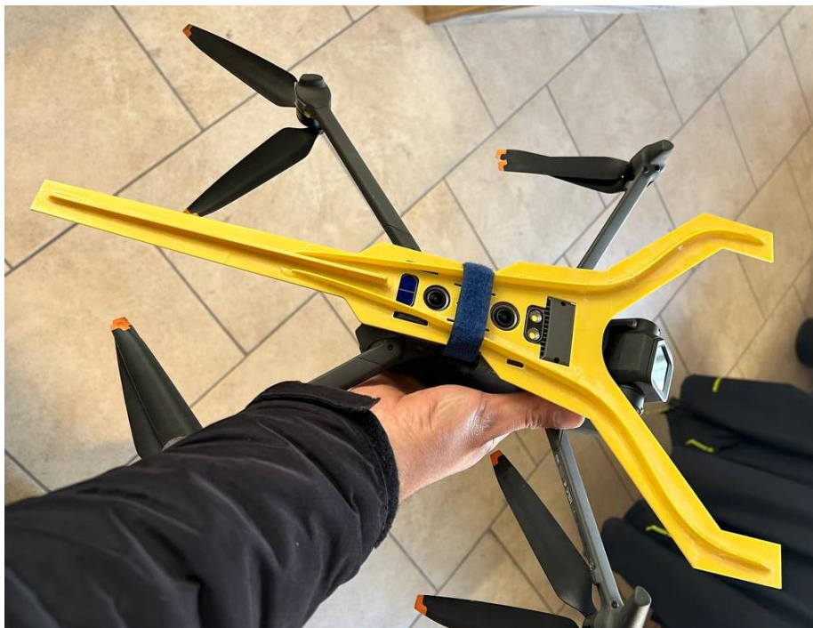
Рисунок 2 – Платформа-рогатка з текстоліту для кріплення до БПЛА типу Mavic
