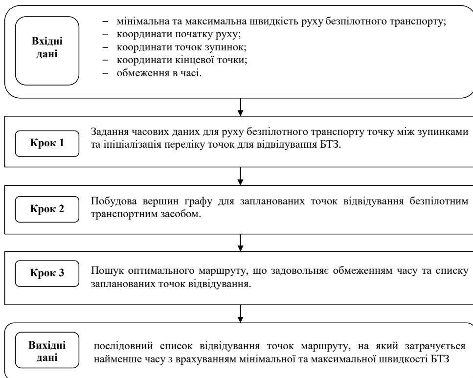
Рисунок 2 – Схема методу визначення оптимального маршруту безпілотної транспортної засоби
