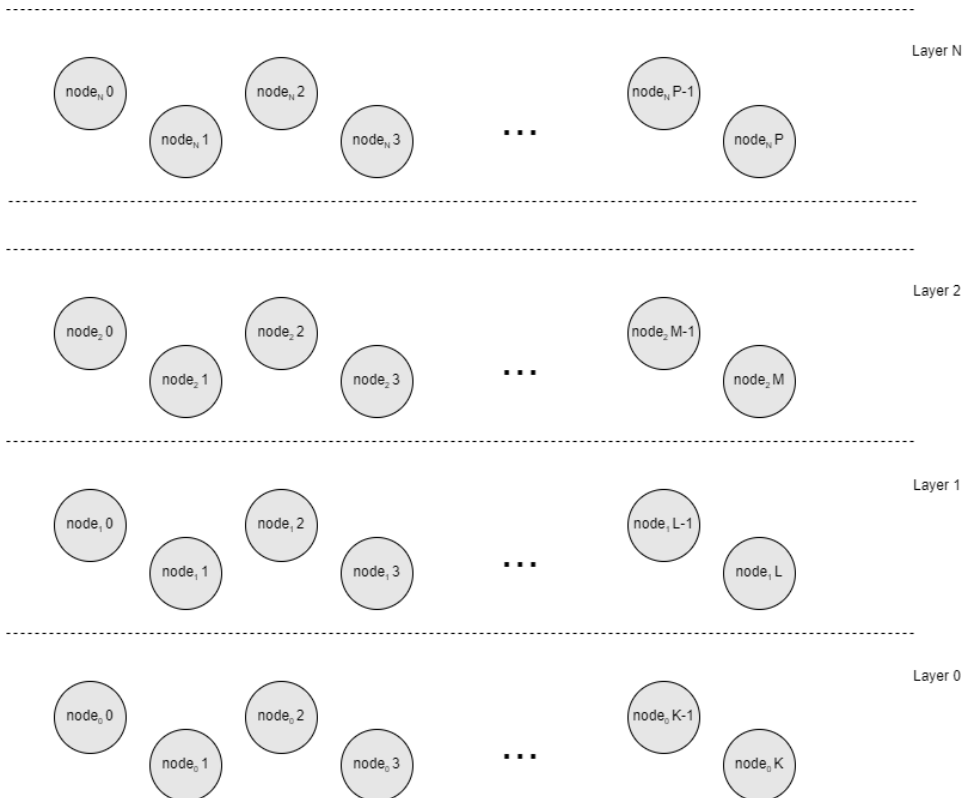
Рисунок 1 – Багаторівнева однорангова мережа та вузли розподілені на рівнях
