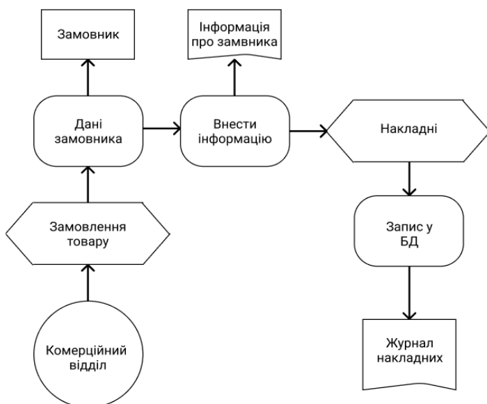
Рисунок 1 – Функціональна схема програмного продукту
