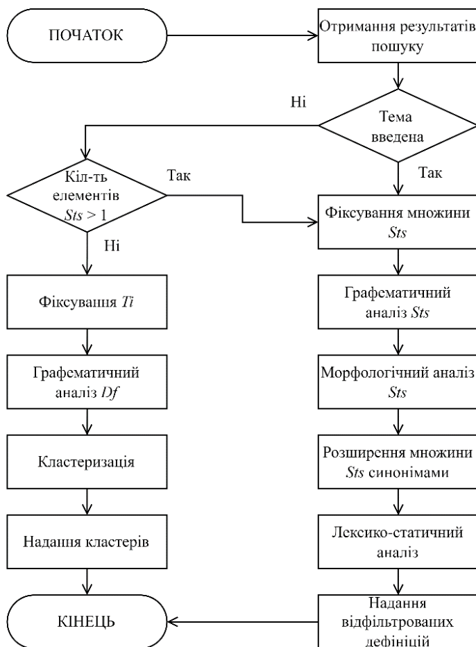
Рисунок 1 – Алгоритм фільтрації тлумачень
