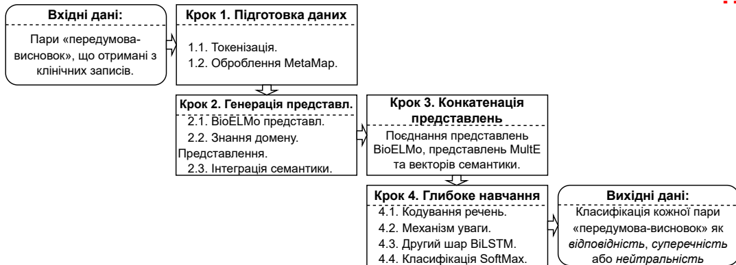
Рисунок 6: Загальна схема: Підготовка → Генерація мультимодальних векторів → Механізм уваги → Глибоке навчання (ESIM).
