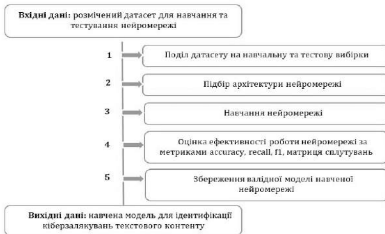
Рисунок 6. Етапи формування навченої моделі аналізу токсичності RNN для виявлення образливого мовлення
